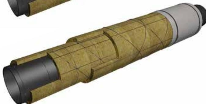
Изоляция трубопроводов матами ISOTEC в два слоя с креплением проволочными стяжками, кольцами и бандажами
