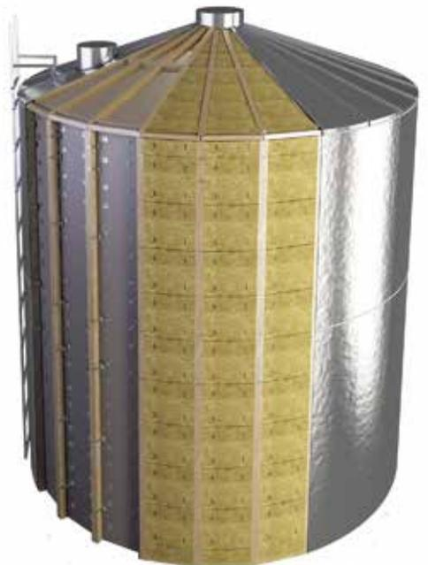
Изоляция вертикальных аппаратов матами или плитами ISOTEC с креплением проволочным каркасом и штырями, металлическим защитным покрытием с опорным разгрузочным каркасом
