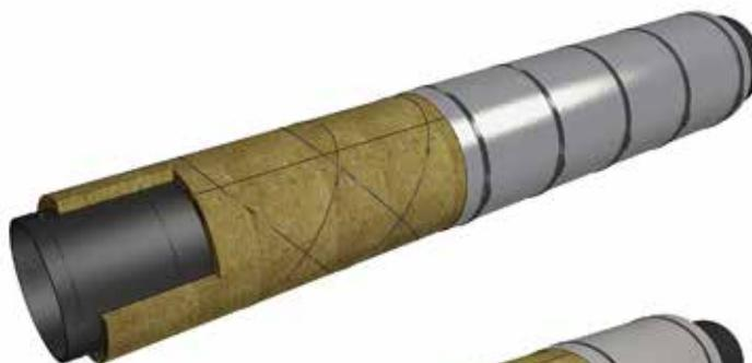
Изоляция трубопроводов матами ISOTEC в один слой с креплением проволочными стяжками и бандажами
