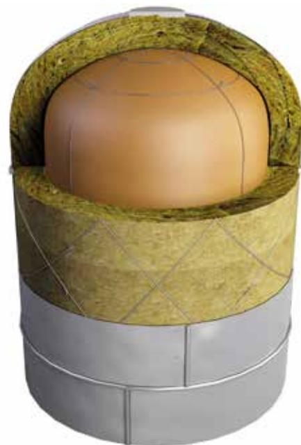
Изоляция вертикальных аппаратов матами или плитами ISOTEC с креплением проволочным каркасом и металлическим защитным покрытием
